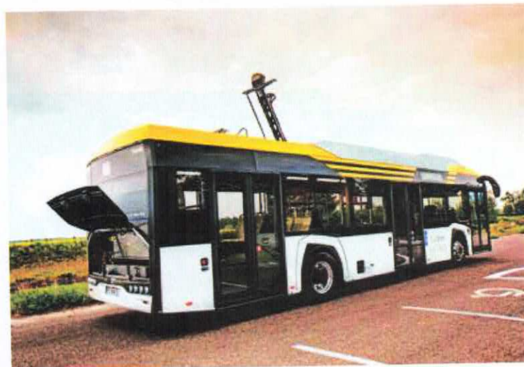
Tylna ściana z otwartą komorą zestawu baterii i elementów sterowania mocą. Na dachu widoczny jest pantograf szybkiego ładowania
