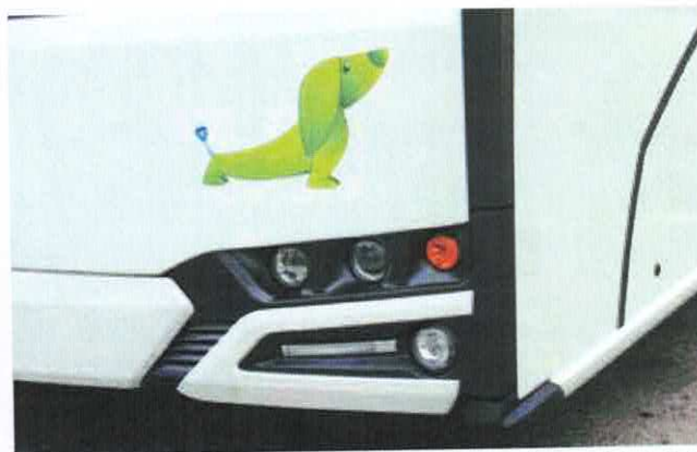
W dalszym ciągu jednym z charakterystycznych elementów new Solaris Urbino jest nowy kształt przednich reflektorów, wykonanych w technologii LED
