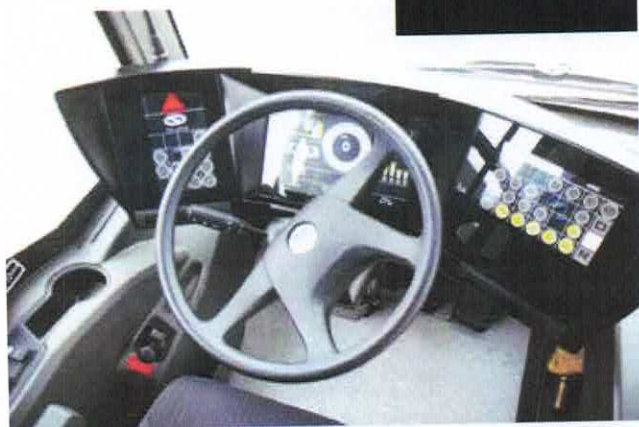
Nowa deska rozdzielcza konstrukcji inżynierów Solarisa. Na desce pojawił się piktogram informujący kierowcę o stanie naładowania baterii oraz o optymalnym położeniu pojazdu przy podjeździe pod ładowarkę pantografową
